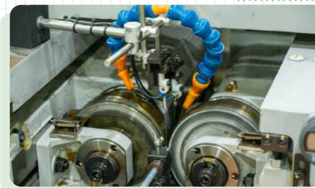
センサを設置した転造機。 2つの転造ロールの間に針状のセンサがある
